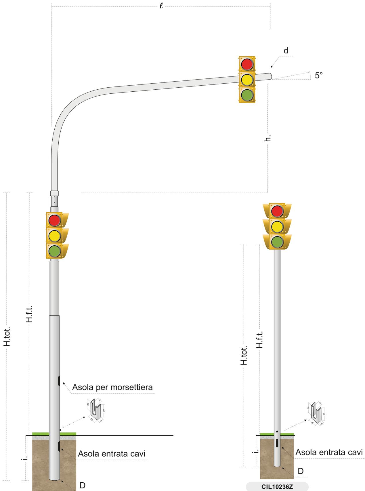
I nostri pali per impianti semaforici sono costruiti utilizzando pali rastremati saldati longitudinalmente ad induzione, realizzati in lamiera d'acciaio S235JR (EN 10219-01). I tubi, di differenti diametri, vengono uniti tra loro mediante saldatura circonferenziale in corrispondenza delle rastremature.
