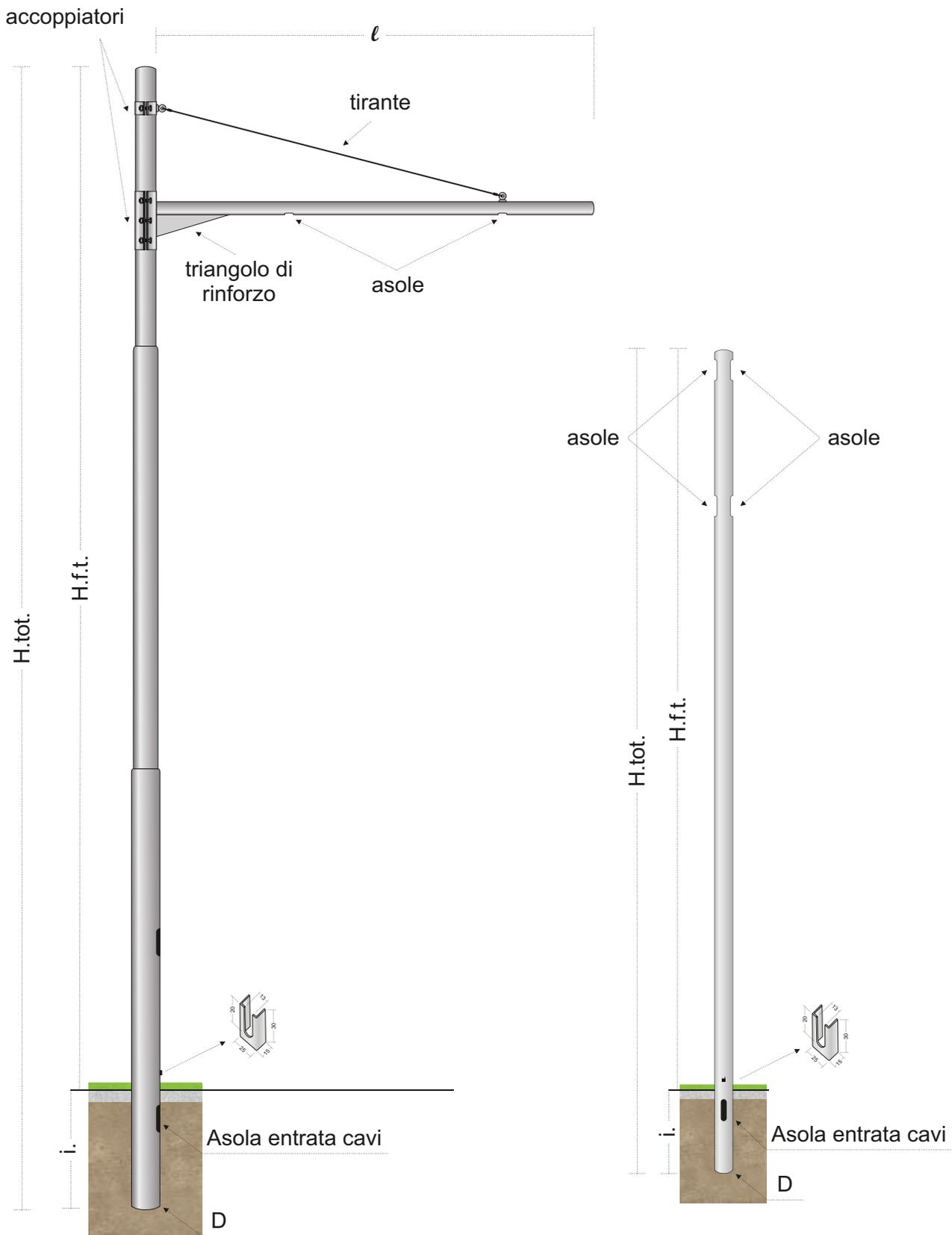
I nostri pali per impianti di videosorveglianza e ZTL sono costruiti utilizzando pali rastremati saldati longitudinalmente ad induzione, realizzati in lamiera d'acciaio S235JR (UNI EN 10219-01).
